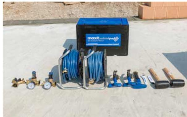
Werkzeug-Kit für den optimalen Wasserdruck vor Ort.
