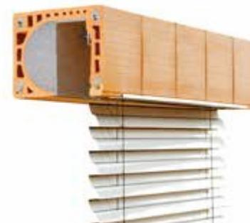
Vorgefertigte Rolläden und Jalousiekästen sind nicht – bzw. nur sich selbst tragende Bauteile und machen einen Sturz erforderlich
