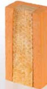
**Fensteranschlagschalen** werden flächig mit Dünnbettmörtel auf der dämmstoffgefüllten Seite benetzt und an die Fensterlaibung (Sturzbereich) angemörtelt. Im Laibungsbereich kann eine zusätzliche Bewehrung mit Flachstahlankern für eine kraftschlüssige Verbindung sorgen.
