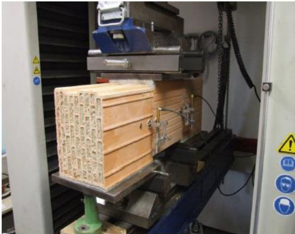
Bild B10: Haftscherversuche an 3-Steinprüfkörpern nach DIN EN 1052-3 Planhochlochziegel / Mörtelband bzw. Dünnbettmörtel 900D Prüfkörper und Versuchsaufbau
