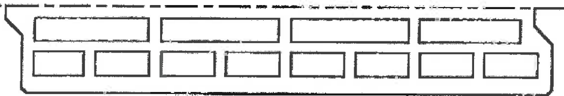
b) Lochbildvariante der äußeren Kernreihe des NE-Ziegels
