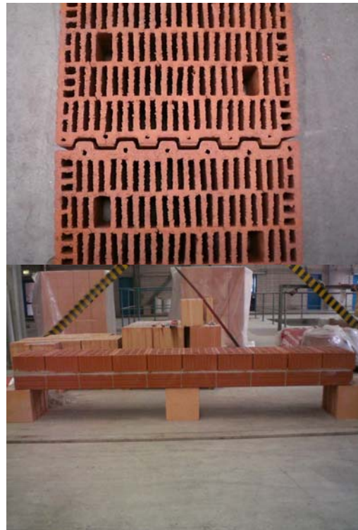
Bild 8: Tastversuche zur Durchbiegung von Flachstürzen mit einlagiger Übermauerung; Ausführung der Stoßfuge und Übersicht
